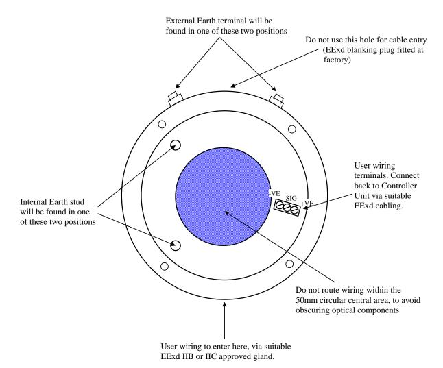
RECEIVER REQUIRES 3 CORE SCREENED WIRING TO CONTROLLER UNIT, PLUS ENCLOSURE EARTH BONDING.
