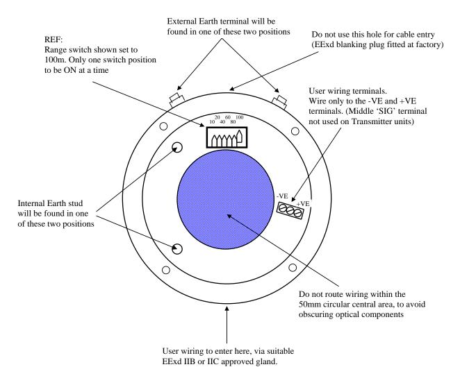
TRANSMITTER REQUIRES 2 CORE SCREENED WIRING TO SUITABLE POWER SUPPLY, PLUS ENCLOSURE EARTH BONDING.
