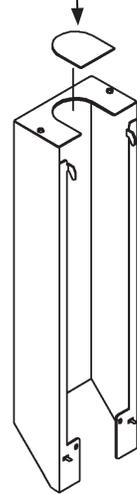
For pole diameters 38 - 39 mm, remove the cap knockout. Если столб имеет диаметр 38-39 мм, снимите заглушку.
