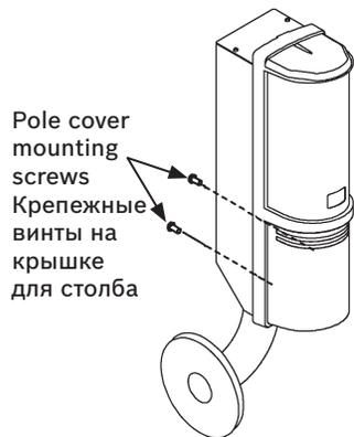
1. Attach the chassis to the pole. Прикрепите шасси к столбу.
