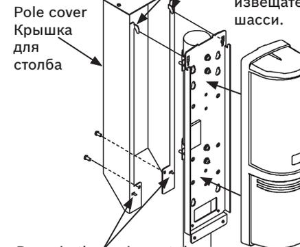
Press in the springs at the bottom. Нажмите на пружины, расположенные внизу.
