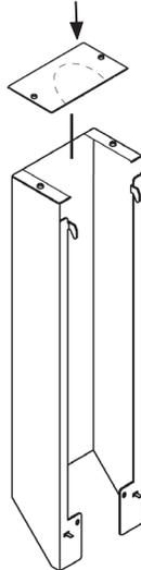
For pole diameters 39 - 43 mm, remove the cap. Если столб имеет диаметр 39-43 мм, снимите всю верхнюю часть.
