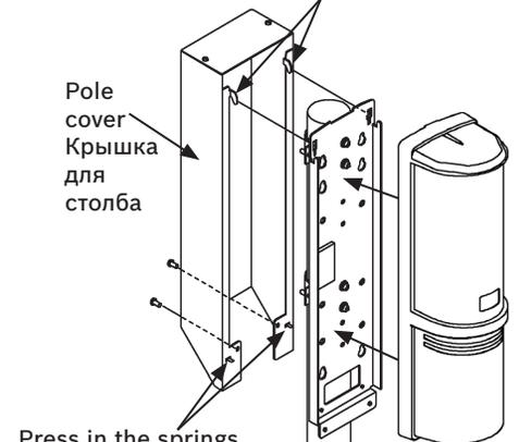
Press in the springs at the bottom of the cover. Нажмите на пружины, расположенные в нижней части крышки.
