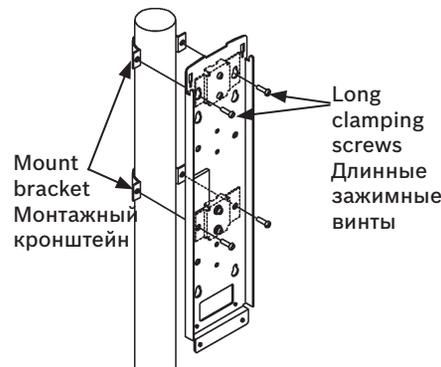
2. Mount detector and attach pole cover. Смонтируйте извещатель и установите крышку для столба.
