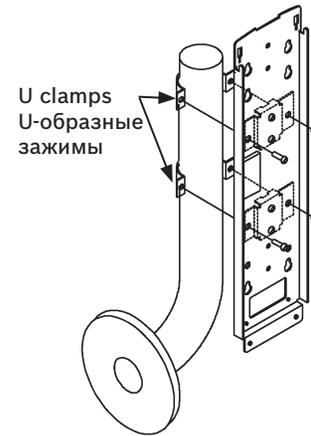
2. Mount detector and attach pole cover. Смонтируйте извещатель и установите крышку для столба.
