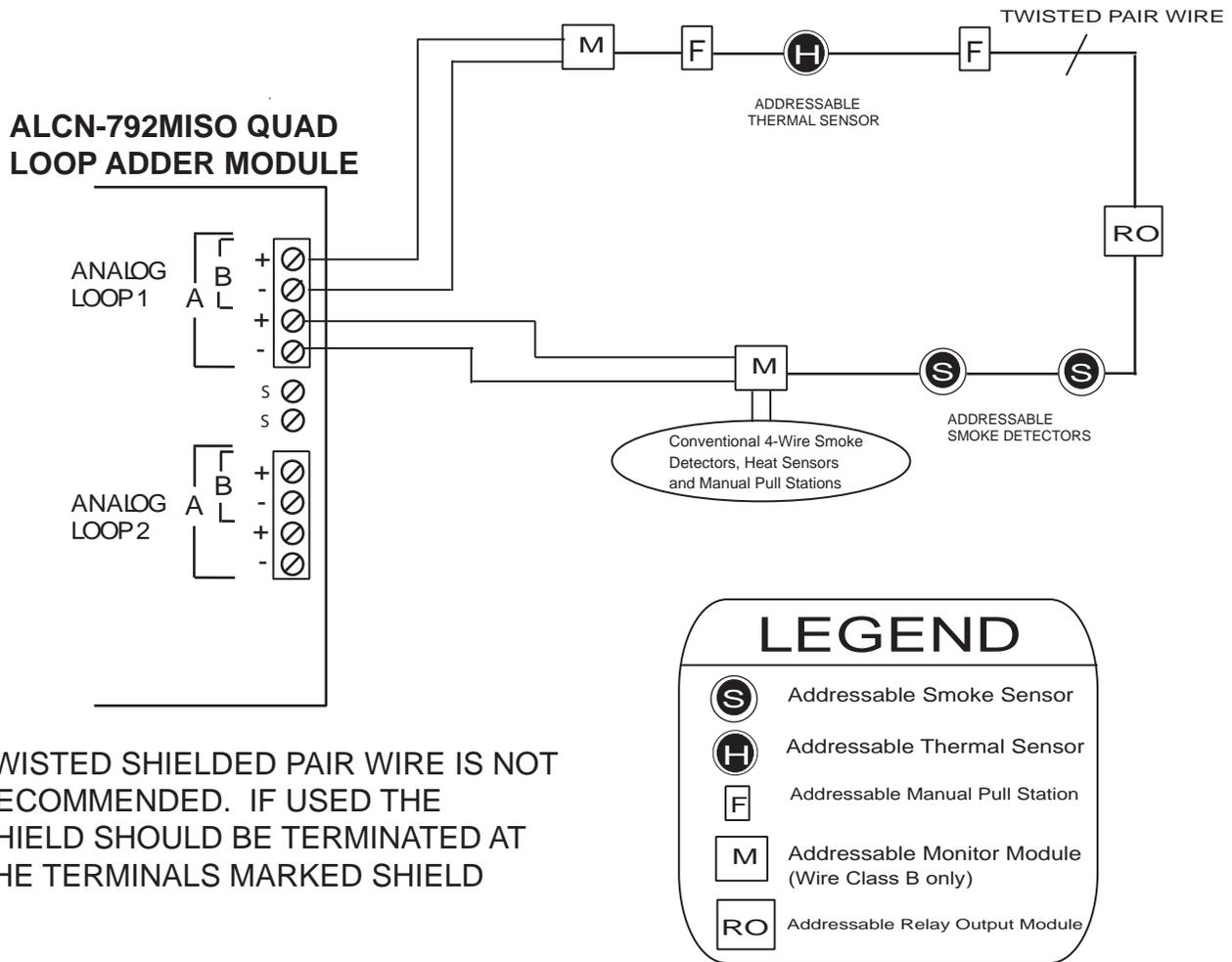
TWISTED SHIELDED PAIR WIRE IS NOT RECOMMENDED. IF USED THE SHIELD SHOULD BE TERMINATED AT THE TERMINALS MARKED SHIELD
